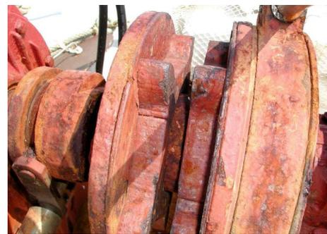
Circa la resistenza meccanica del salpancore esso viene proporzionato per un certo numero di volte la massa dell'ancora e catena insieme; ad esempio se la somma delle masse dell'ancora e catena ammontano a 300 kg, il salpancore deve poter sviluppare uno sforzo di trazione pari a 10 o 15 volte il valore precedente ovvero da 3000 a 4500 kg.
