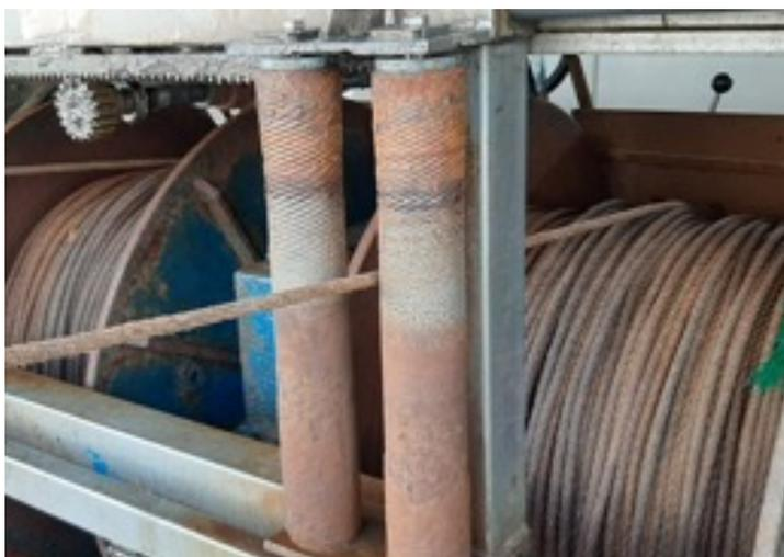
Anche i rulli del guida cavi vanno dimensionati in modo da evitare l'incisione degli stessi per l'azione laterale.
